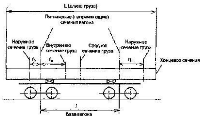
Рис.П.2.1. Схема сечений груза, погруженного на одиночный вагон
